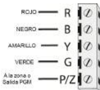
Figure 2-27 Terminales P/Z del teclado
