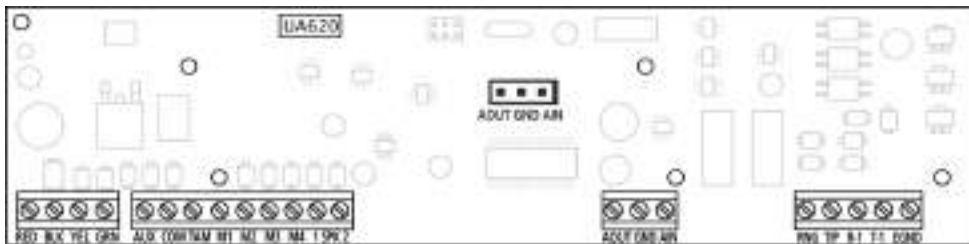
Figure 2-21 Módulo de audio bidireccional HSM2955
