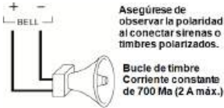
Figure 2-33 Cableado de terminales sirena
