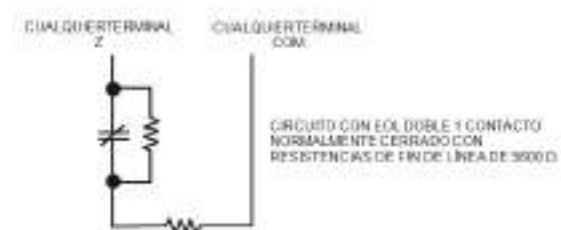
Figure 2-30 Cableado de DEOL
