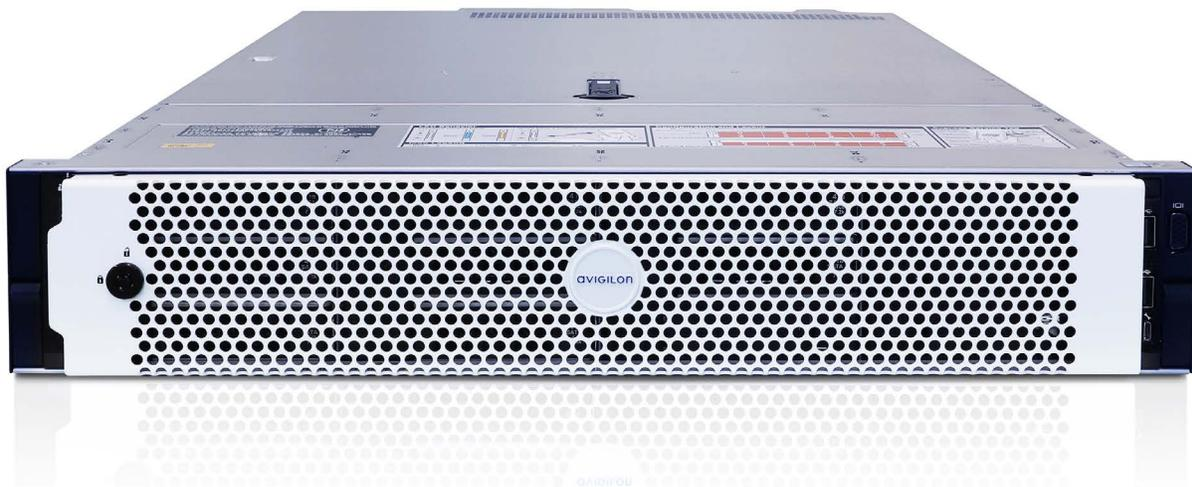
HD NVR4 Standard de Avigilon es un grabador instalable en bastidor 2U que se fabrica específicamente para el ecosistema de las soluciones Avigilon con la flexibilidad necesaria para ampliar el sistema de vigilancia.
