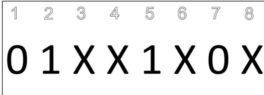
En donde indica que los espacios (dips de un switch, pads de una pca, o cualquier otra presentación) deben ir programados como se muestra en la imagen anterior:
