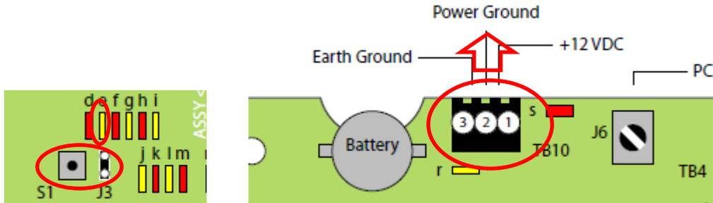
Paso 2.- Presionar y mantener presionado el botón S1; Reconectar la corriente del controlador
