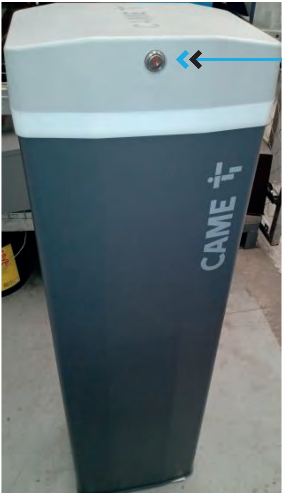
CERRADURA PARA EL DESBLOQUEO DEL MÁSTIL (MANUAL AUTOMÁTICO) (Si esta abierto manda un mensaje de error y no opera la barrera)
