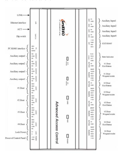
En la FR1200 se hace la siguiente configuración dependiendo que posición de lectora tendrá el dispositivo. Posición 1 y 2 son de la puerta 1 en entrada y salida, posición 3 y 4 son para la puerta 2 en entrada y salida, posición 5 y 6 son para la puerta 3 de entrada y salida, posición 7 y 8 puerta 4 de entrada y salida.
