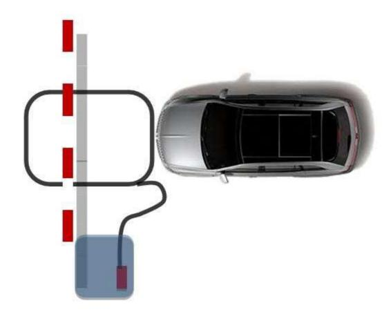
• Solo queda entonces verificar que cuando un vehículo este en la zona de "peligro", este sea detectado, esto lo sabemos a través del LED verde indicador en el sensor de masa, y el LED indicador en el panel de control de la barrera.
