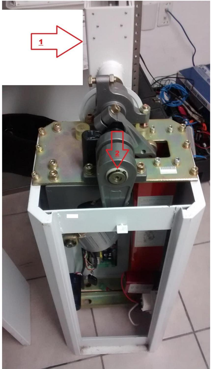
3- localizamos la unión de tuerca que nos dará el ajuste necesario de la posición final de apertura.
